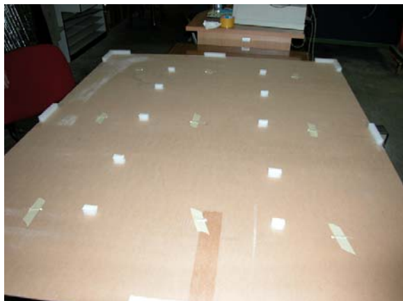
Figura 3 – Pannello in legno con sonde di temperatura installate internamente ad esso
