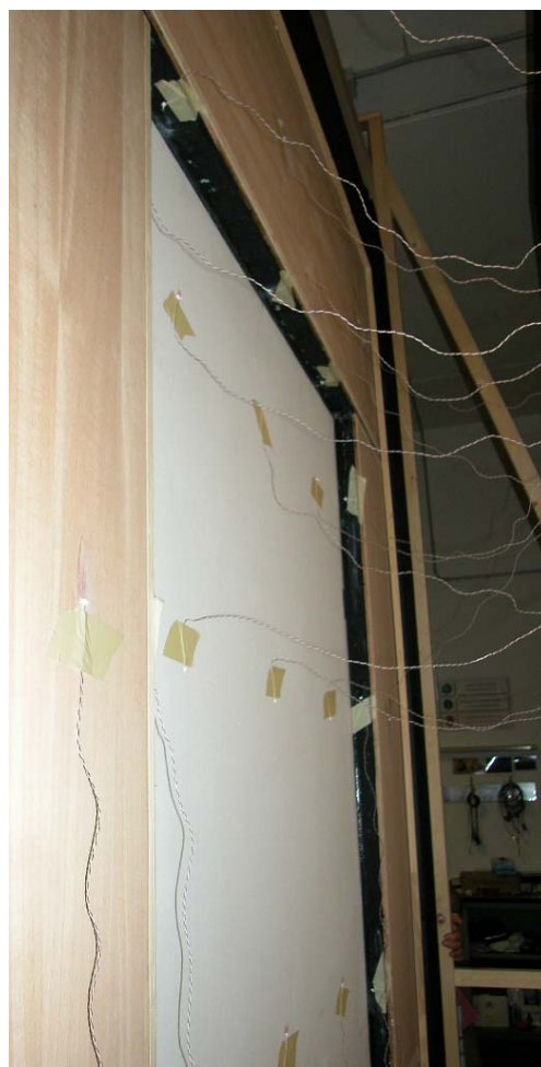
Figura 4 – Campione di prova installato nell'apparato di misura; lato caldo (pannello di legno) e lato freddo (pannello in ossido di magnesio)
